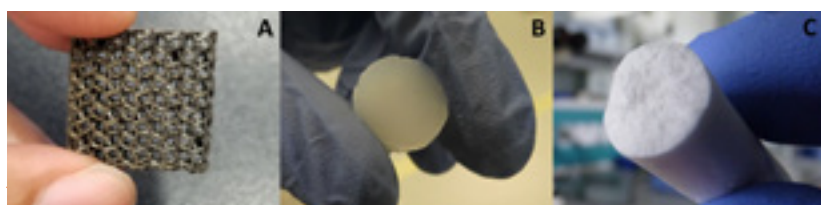
Esempi di materiali porosi realizzati all'interno del progetto REGENERA: A) struttura metallica realizzata in lega di titanio usando la tecnica del metal laser sintering; B) hydrogel ottenuto a partire da miscele di fibroina della seta e alginati e ottenuto per acidificazione mediante CO 2 ad alta pressione; C) spugna di fibroina della seta realizzata mediante schiumatura di soluzione acquosa con espansione gassosa (N 2 ).
