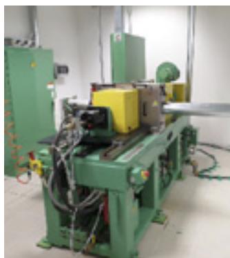
Figura 1: Strumentazione per il testing tribologico dei materiali di attrito; a) Tribometro pin-on-disc; b) Banco mini-dyno.
