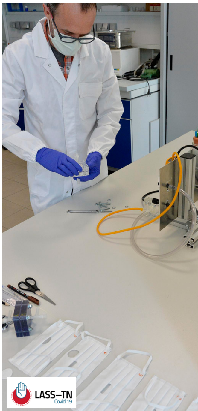
Figura 2: Set-up di allestimento presso il laboratorio DII UniTrento per la valutazione della respirabilità delle mascherine con il tecnico Luca Benedetti che si è occupato delle misure.
