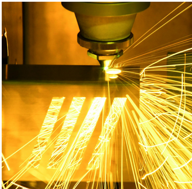
Processo di taglio laser su tubo di acciaio Inox.
