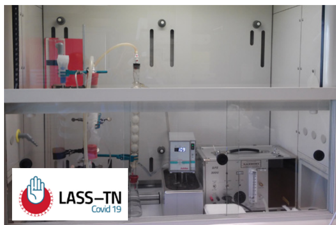
Figura 1: Banco di misure per le prove di Bacterial Filtration Efficiency (BFE), realizzato dai ricercatori del DII UniTrento e installato presso il laboratorio sanità pubblica dell'APSS di Trento.
