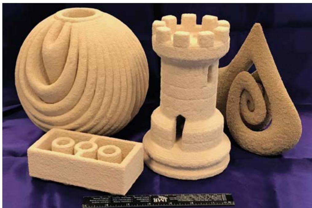
Sopra: Componenti a base di granulato in vetro e cemento magnesiaco realizzati mediante stampa 3D.
