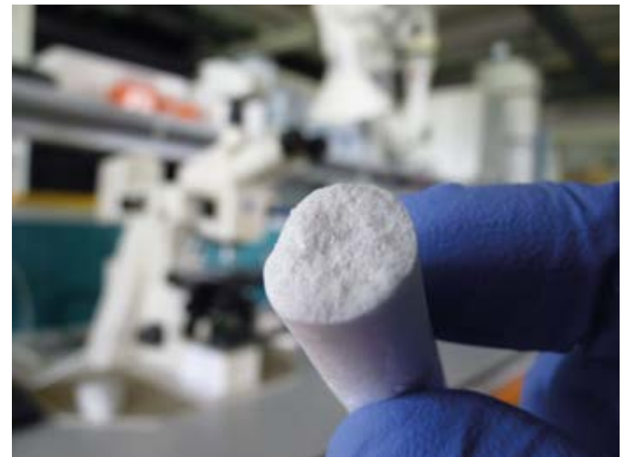
Figura 1: Esempio di schiuma ottenuta mediante espansione di una soluzione di fibroina della seta e asciugata mediante processo di liofilizzazione.
