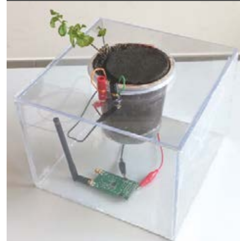
Figura 2: Sensore intelligente completamente autonomo e wireless alimentato da batteri del terreno.
